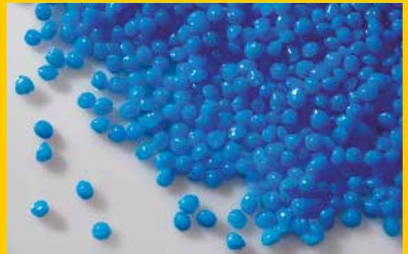
Zusätzlich zur hohen Qualität sorgt auch die gleichmäßige Granulatkörnung für eine homogene Zumischung zur Neuware. NGR ist daher indirekt auch Garant für eine konstante Qualität des Endprodukts.
